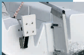
Extra: Motorhalterung zum Hochziehen
